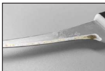
Fio queimado Burned wire | Hilo quemado
